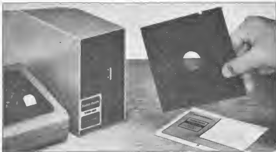
Unidade de leitura e gravação para minidisquete
